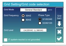
Grid Mode:General Standard、UL1741 & IEEE1547、CPUC RULE21、SRD-UL-1741、CEI 0-21、Australia A、Australia B、Australia C、EN50549\_CZ-PPDS(>16A)、NewZealand、VDE4105、OVE-Directive R25.
